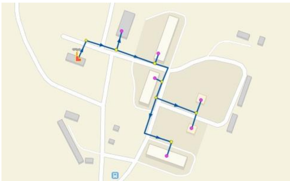
Рисунок 2.34 – Модель системы теплоснабжения котельной Бархотка
